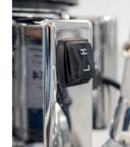
Schalter, um Geschwindigkeiten zu wechseln
