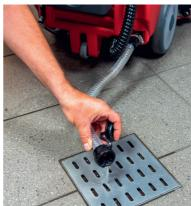
Der Frischwassertank kann restlos abgelassen werden.
