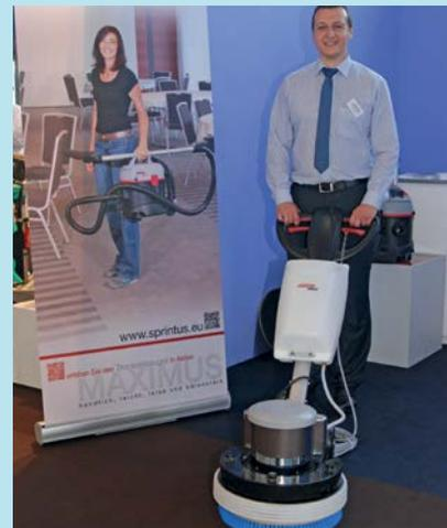
Sprintus-Geschäftsführer Ermin Fazlic zeigte eine robuste Einscheibenmaschine (Hercules). Das Eigengewicht von 48 Kilogramm kann mit zwei optionalen Zusatzgewichten von jeweils 14 Kilogramm aufgerüstet werden.
