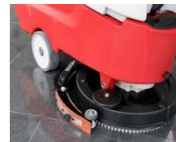
Le suceur d'aspiration pivotante est couplée au timon et tourne automatiquement dans la direction de travail dans les virages.
