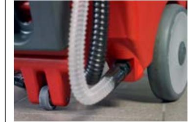
La roue de support permet un transport facile de la machine et les brosses peuvent être déposées en douceur.
