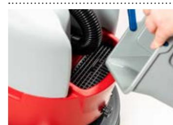
Remplissage facile du réservoir d'eau propre de 15 litres.
