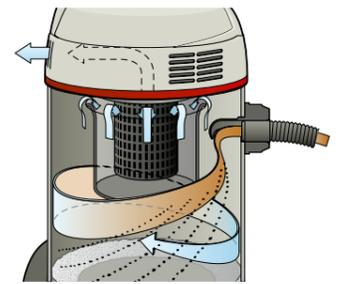
Grâce à la rotation au niveau de l'entrée, le brouillard de fines gouttelettes est séparé contre la paroi du réservoir. L'usage d'autres filtres n'est plus nécessaire. L'interruption automatique par flotteur réagit également en cas de formation massive de mousse. Les fentes latérales pour l'air de refroidissement garantissent une séparation stricte de l'air de refroidissement et de l'air d'exploitation.
