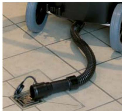
Tuyau de vidange des eaux sales pour un vidange confortable du réservoir.
