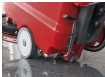
La roue de support permet un transport facile de la machine et une mise à l'arrêt Immédiate des brosses.
