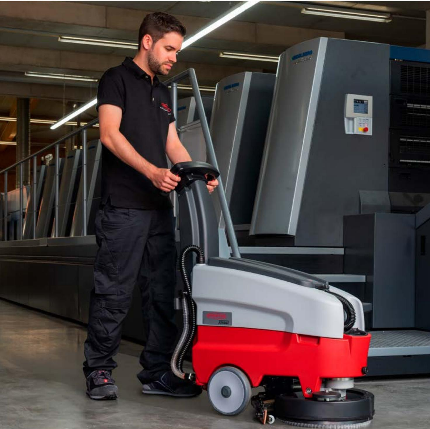
Fonctionnement sur batterie : durée de fonctionnement 75 min. en fonctionnement normal, 120 min. en mode ECO. Pour des surfaces de petite et moyenne taille. Rendement surfacique d'environ 1 260 m<sup>2</sup>/h. Hautes capacités d'aspiration. Le sol devient absolument sec et est directement accessible.
