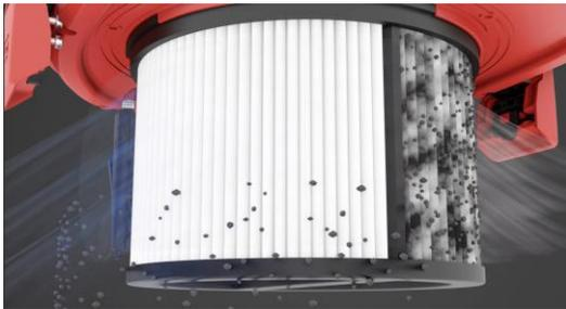
**Abbildung 2:** Die CraftiX Sicherheitssauger der Staubklasse H sind mit einem patentierten HEPA 14 Patronenfilter ausgestattet. Dieser besteht aus zwei voneinander unabhängigen Filterkammern, die nacheinander abgereinigt werden. Saugstrom und Saugleistung bleiben dadurch auch während der Abreinigung auf einem konstant hohen Niveau, was eine permanente Absaugung garantiert.
