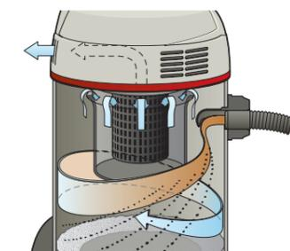
Grâce à la rotation au niveau de l'entrée, le brouillard de fines gouttelettes est séparé contre la paroi du réservoir. L'usage d'autres filtres n'est plus nécessaire. L'interruption automatique par flotteur réagit également en cas de formation massive de mousse. Les fentes latérales pour l'air de refroidissement garantissent une séparation stricte de l'air de refroidissement et de l'air d'exploitation.
