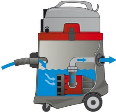
**Abbildung 2:** Der Pumpsauger N 51/1 KPS saugt Wasser durch den Saugschlauch an. Die integrierte Schmutzwasserpumpe fördert das gesammelte Wasser sofort durch den auf der Rückseite des Gerätes angebrachten C-Rohr-Anschlusses weiter. Die Förderleistung der Pumpe liegt bei bis zu 14.000 Liter Schmutzwasser pro Stunde.
