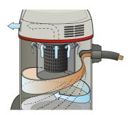
Grâce à la rotation au niveau de l'entrée, le brouillard de fines gouttelettes est séparé contre la paroi du réservoir. L'usage d'autres filtres n'est plus nécessaire. L'interruption automatique par flotteur réagit également en cas de formation massive de mousse. Les fentes latérales pour l'air de refroidissement garantissent une séparation stricte de l'air de refroidissement et de l'air d'exploitation.
