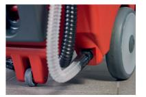
La roue de support permet un transport facile de la machine et les brosses peuvent être déposées en douceur
