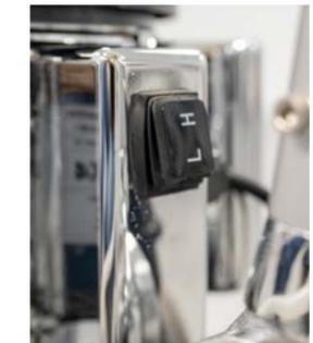
Schalter für den Wechsel zwischen den Arbeitsgeschwindigkeiten.
