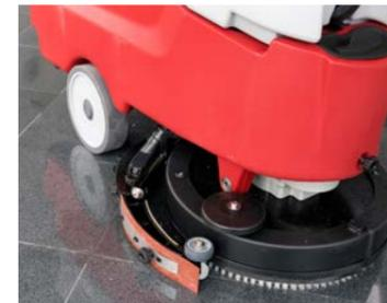
Saugbalken schwenkt automatisch in die Arbeitsrichtung.
