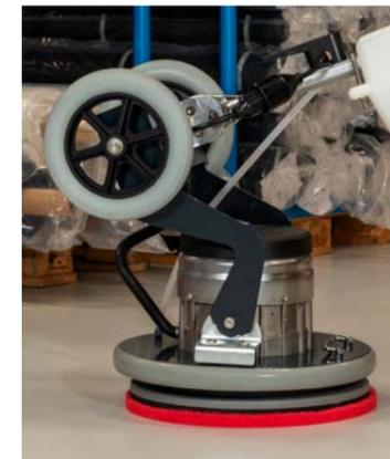
Kippbare Deichsel zur Erhöhung des Anpressdruckes.
