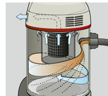
Durch den Drall am Einlassstutzen wird der Sprühnebel an der Behälterwand abgeschieden. Zusätzliche Filterstoffe sind nicht mehr notwendig. Die zuverlässige Schwimmerabschaltung reagiert selbst bei extremer Schaumbildung. Seitliche Kühl-Luftschlitze sorgen für konsequente Trennung von Kühl- und Prozessluft.
