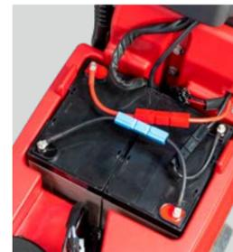
Die wartungsfreien 33 Ah Gel-Batterien sind über die Schnellkupplungen werkzeuglos entnehmbar.
