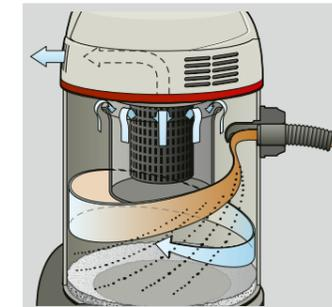
Durch den Drall am Einlassstutzen wird der Sprühnebel an der Behälterwand abgeschieden. Zusätzliche Filterstoffe sind nicht mehr notwendig. Die zuverlässige Schwimmerabschaltung reagiert selbst bei extremer Schaumbildung. Seitliche Kühl-Luftschlitz sorgen für konsequente Trennung von Kühl- und Prozessluft.
