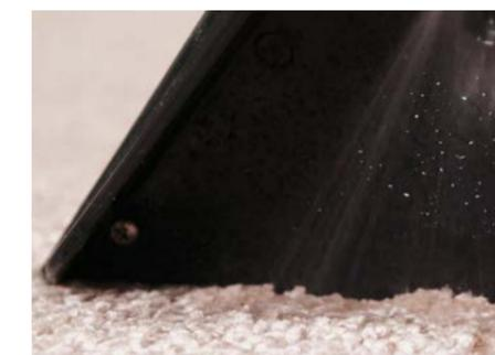
Reinigungsmittel wird bei Bedarf aufgesprüht.
