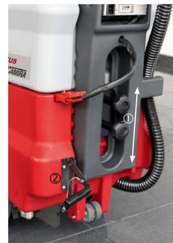
① Die Arbeitshöhe der Bedieneinheit kann individuell eingestellt werden.
