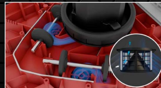
Die Filterabreinigung erfolgt durch Lufrückspülung und sorgt dank des patentierten Patronenfilters dafür, dass die feinen Poren des Filters rückstandslos von Staub befreit werden. Die Wartung und Reinigung des Filters entfällt und Sie sparen Zeit und Kosten.
