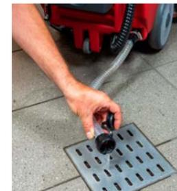
Der Frischwassertank kann restlos abgelassen werden.
