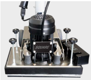
Einfacher Transport: schnelle (De-)Montage der Gewichte
